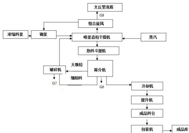
图 3-2-2 赖氨酸工艺流程图及产污节点
